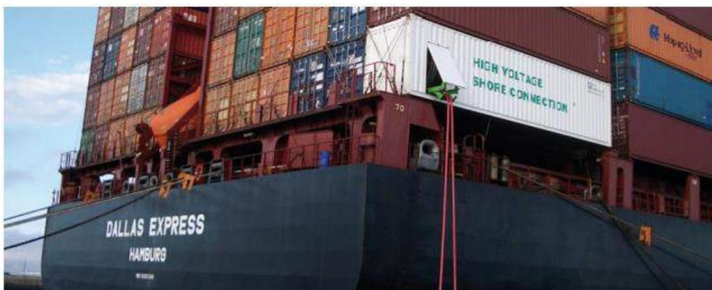
**Figura 10** - Sistema di connessione elettrica nave-banchina: Hans Hillewaert /wikipedia.org.
