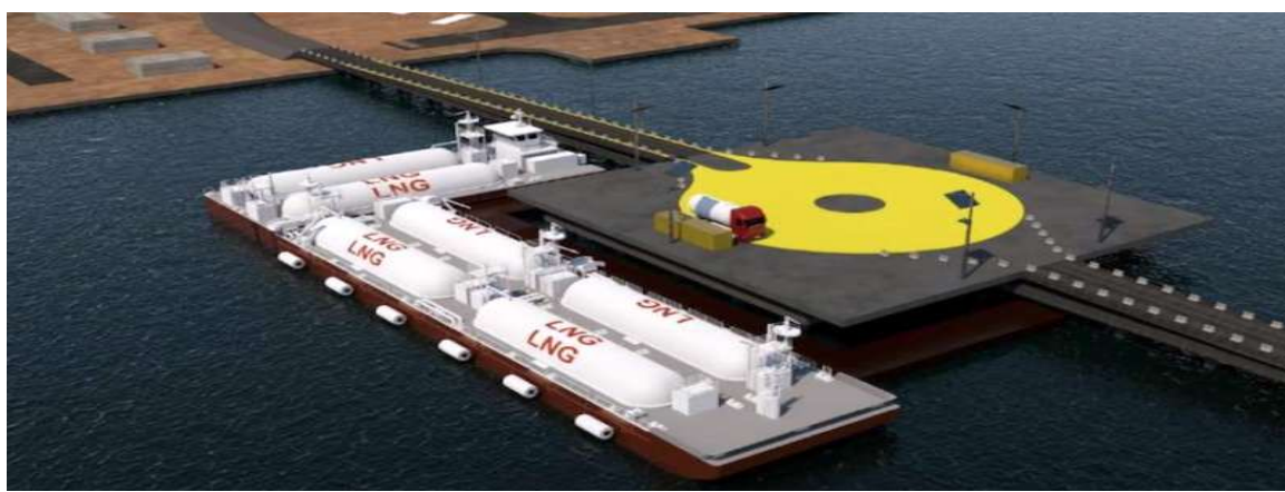
Figura 21 - Rendering rifornimento GNL su base galleggiante.
